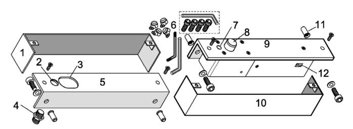
FIG. 1 LOCK AND RECEIVER PARTS
